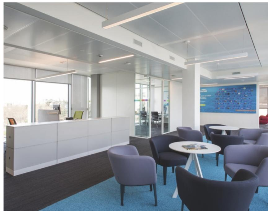
Gli spazi di lavoro sono climatizzati mediante un controsoffitto a pannelli radianti in lamiera microforata, che permette anche la diffusione dell'aria di rinnovo (Francesco Dolfo – Tétris).
